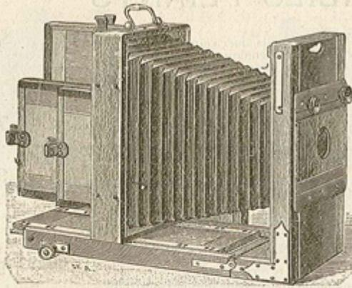
**Chambre noire " Au BON MARCHÉ " n° 1**, en noyer ciré avec bande cuivre, double accrochement, soufflet conique toile, queue pliante et rentrante à double crémaillère, cadre verre dépoli à charnière, fermeture à loqueteau, long tirage; planchette d'objectif à déplacement horizontal et vertical, 5 châssis doubles noyer ciré à 1/2 rideaux.
