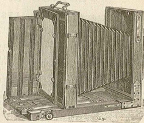
**Chambre noire " Au BON MARCHÉ " n° 2**, en noyer 1/2 verni, modèle riche, ferrures cuivre poli, soufflet conique en peau, chariot à panneaux, niveau d'eau, double crémaillère pour la mise au point, 2 planchettes d'objectif à double déplacement, 5 châssis doubles, 1/2 rideaux.
