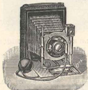
Fig. 88. — DELTA-FOLDING pour plaques 9x12 en hauteur, chambre extra-mince, légère, employant le nouveau châssis à feuillures, chariot aluminium, gainage cuir, double décentrage, obturateur Antre, mise au point variable, 3 châssis.
