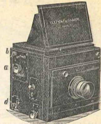
Fig. 126 — CHAMBRE REFLEX. Modèle à miroir permettant la mise au point rigoureuse de l'objet au moment même de l'opération. Obturateur de plaque à fente réglable de l'extérieur donnant des vitesses jusqu'à 1/1000° de seconde. Déclenchement au doigt pour l'instantané et la pose. Couverture en peau de bœuf premier choix, ferrures oxydées, 3 châssis doubles en bois noir vernis, entièrement à rideaux. Deux écrous de pied. Objectif anastigmat f/6, 3, série II à 6 lentilles. (Le Panorthostigmat de Clément et Gilmor.
